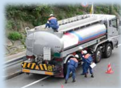
移動タンク貯蔵所路上立入査察
